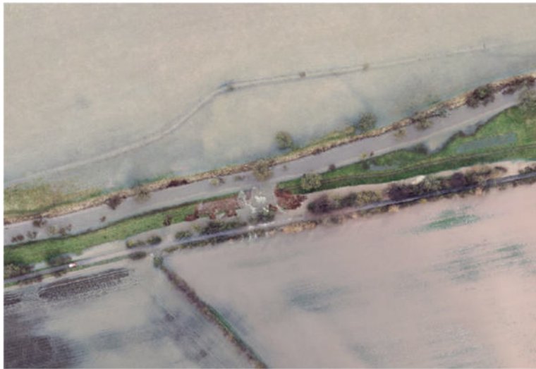
Abbildung 55 Detailaufnahme aus Orthofoto Deichöffnung rechter Helmedeich oberhalb Nikolausrieth
