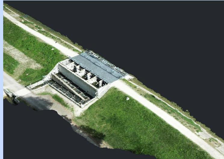
Abbildung: Beispielmodell einer 3D-Punktwolke (Quelle: INROS LACKNER SE)
