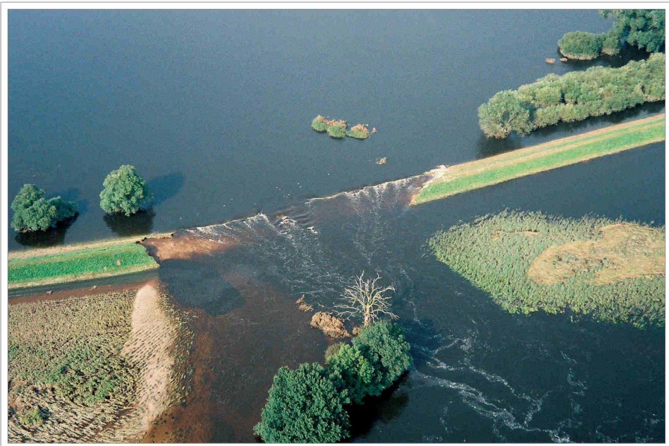
Abb. 6.7: Bruchstelle des linken Elbedeiches bei Seegrehna unterhalb von Wittenberg am 25. August 2002. Durch die Bruchstelle (100 Meter breite Lücke) wurden bis zu 200 Kubikmeter/Sekunde in die überschwemmte Fläche von 50 Quadratkilometern abgeleitet. (Foto: M. Simon)
