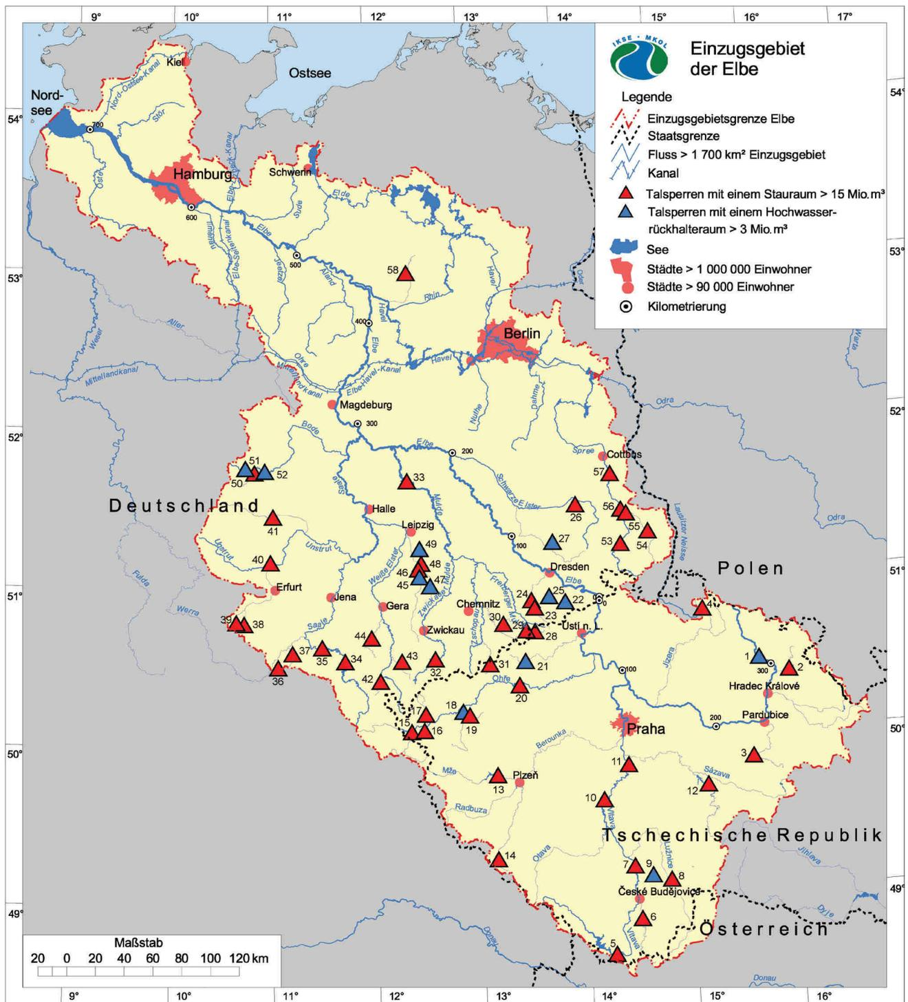
Abb. 8.2: Große Talsperren im Einzugsgebiet der Elbe mit einem Stauraum von mehr als 15 Millionen Kubikmeter und Talsperren mit einem Stauraum unter 15 Millionen Kubikmeter, aber mit einem gewöhnlichen Hochwasserrückhalteraum über 3 Millionen Kubikmeter (IKSE, M. Simon)
