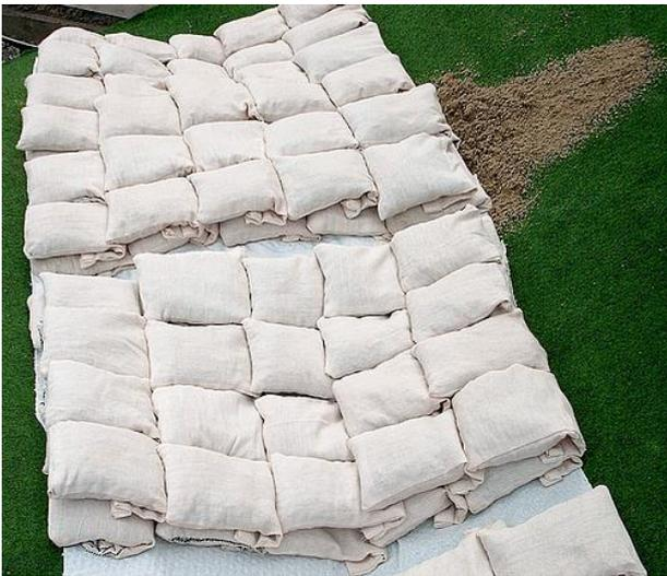
Foto 34: Fußsicherung am Modell
