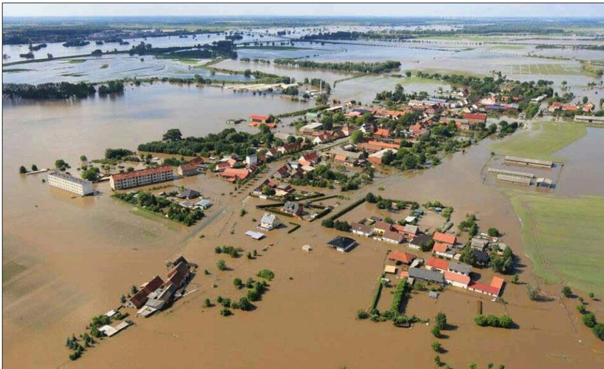
**Abbildung 4.4:** Die Ortschaft Fischbeck und umliegende Dörfer wurden nach dem Bruch eines Elbedeichs völlig überflutet, weil das Wasser über Tage durch den Riss ins Hinterland strömen konnte (Quelle: LHW).
