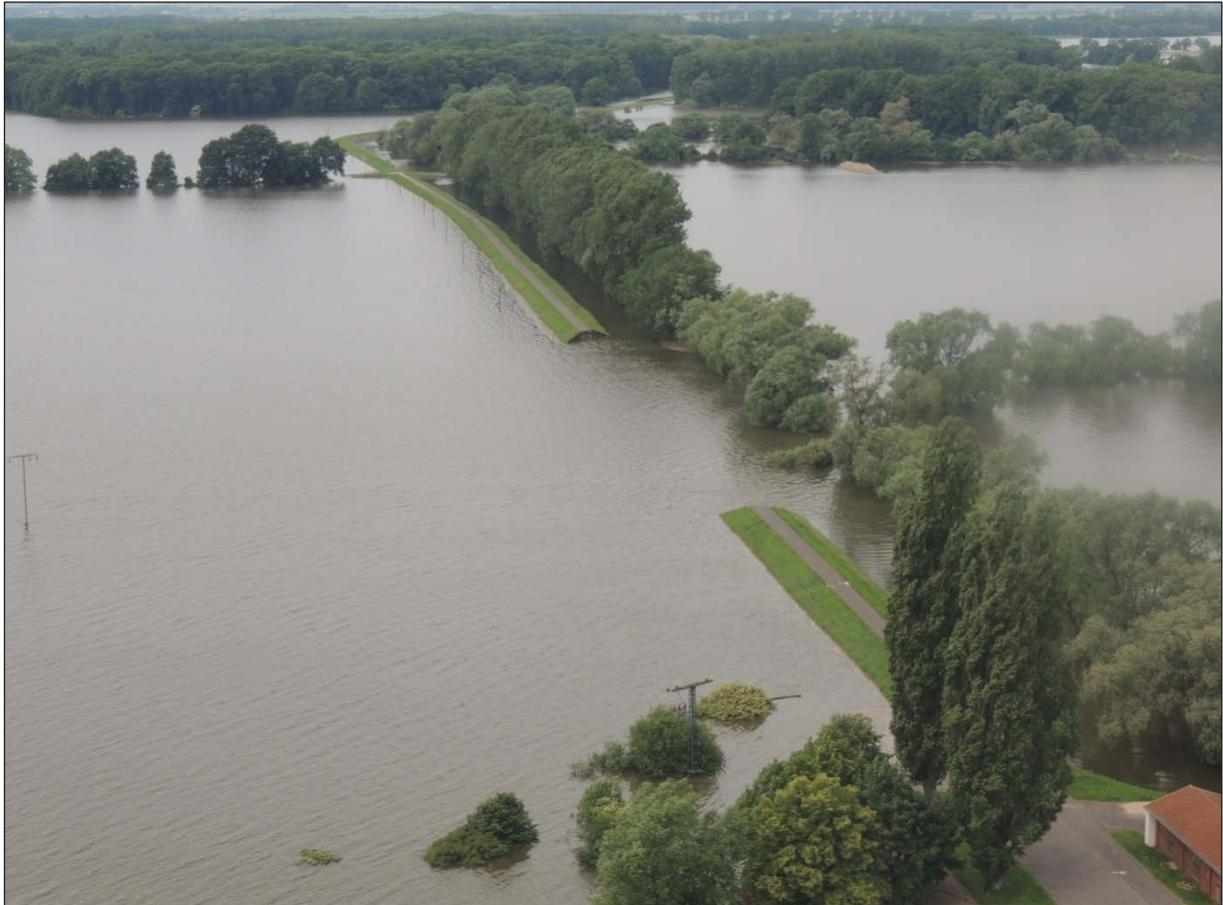
**Abbildung 4.11:** Die Luftaufnahme vom 13. Juni 2013 zeigt die Bruchstelle des rechtsseitigen Saaledeichs bei Breitenhagen. Rechts unten ist das Schöpfwerk Breitenhagen zu sehen (Quelle: LHW).
