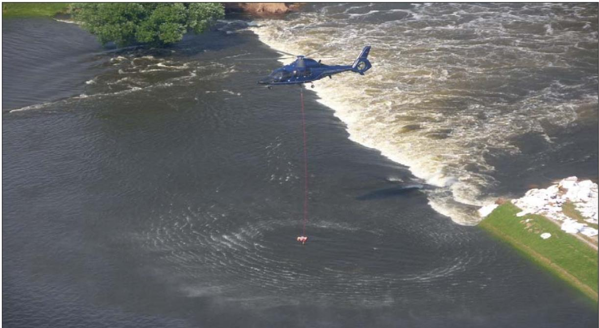
**Abbildung 2.5:** Durchflussmessung vom Hubschrauber aus an der Deichbruchstelle Fischbeck (Quelle LHW).
