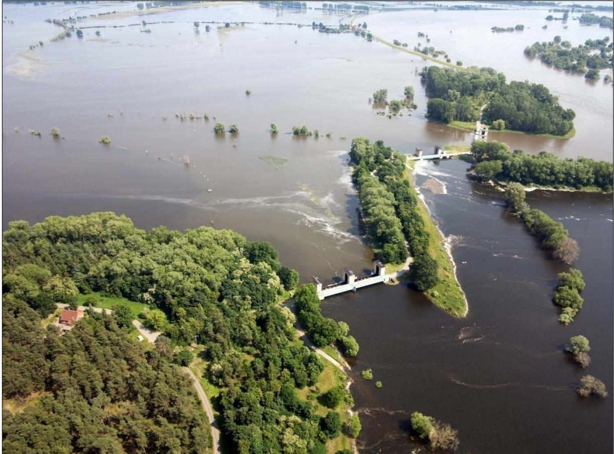
**Abbildung 2.6:** Mit der Wehranlage Quitzöbel an der Landesgrenze zwischen Sachsen-Anhalt und Brandenburg steuert der Landesbetrieb für Hochwasserschutz und Wasserwirtschaft Sachsen-Anhalt die Flutung der Havelpolder. Rings um die Wehranlage sind die großflächigen Überschwemmungen sichtbar.
