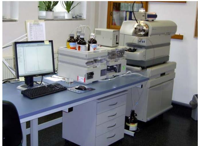
Abb. 2: LC-MS-MS- Analysensystem API 2000
