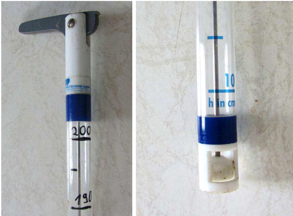
Abbildung 2.1: Schlammpiegelmessgerät der Firma IBB-Umwelttechnik GmbH, links: oberes Ende mit Griff, rechts: unteres Ende mit geöffnetem Einlass
