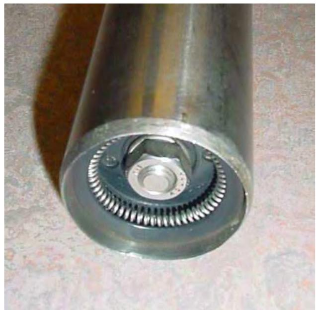
**Abbildung 2.2 : links Pistonsamplern mit Verlängerung, rechts: Sondenunterseite mit Gummiring (pkd.eijkelkamp.com)**
