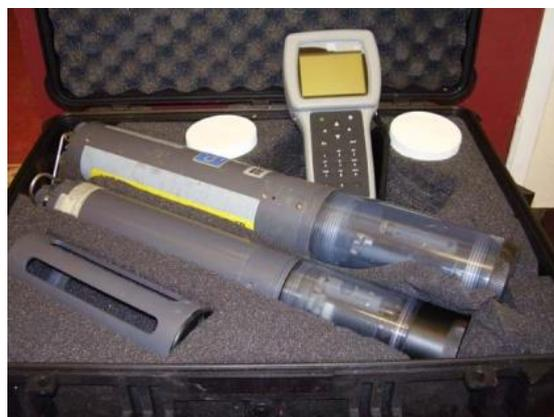
**Abb. 2:** YSI-Sonde zur Bestimmung von Wassertemperatur, pH, Sauerstoffkonzentration und elektrischer Leitfähigkeit (Bildquelle: YSI)
