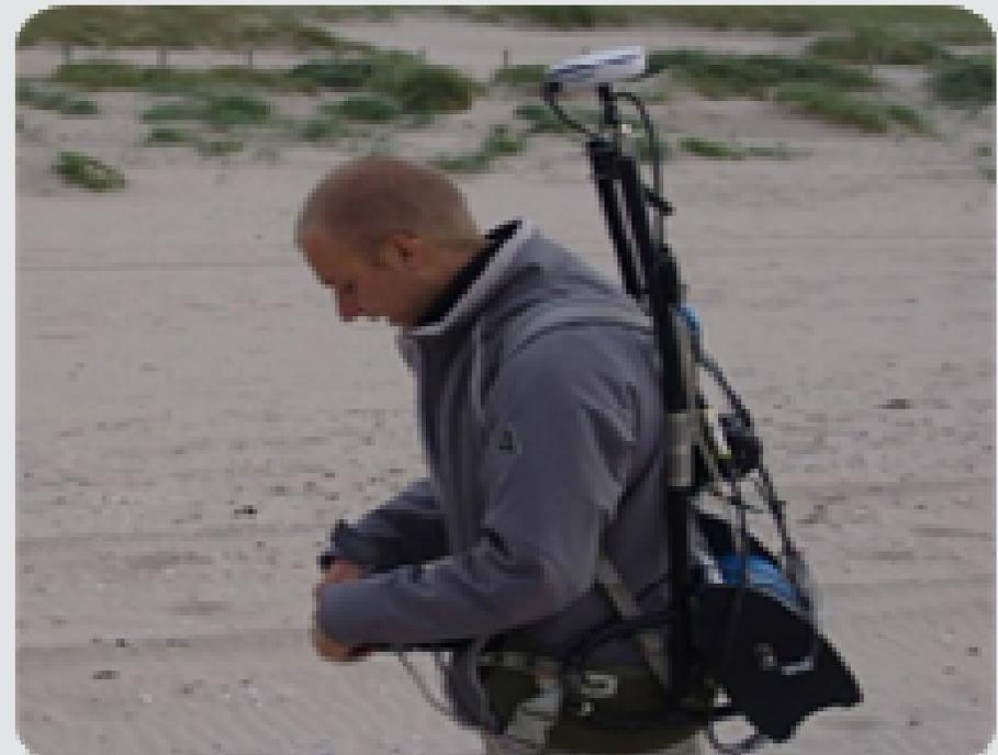
Umrechnung von Flächendaten der natürlichen Gammastrahlung in Karten der Sediment- bzw. Bodenstruktur bzw. in Karten der Kontaminationsniveaus
