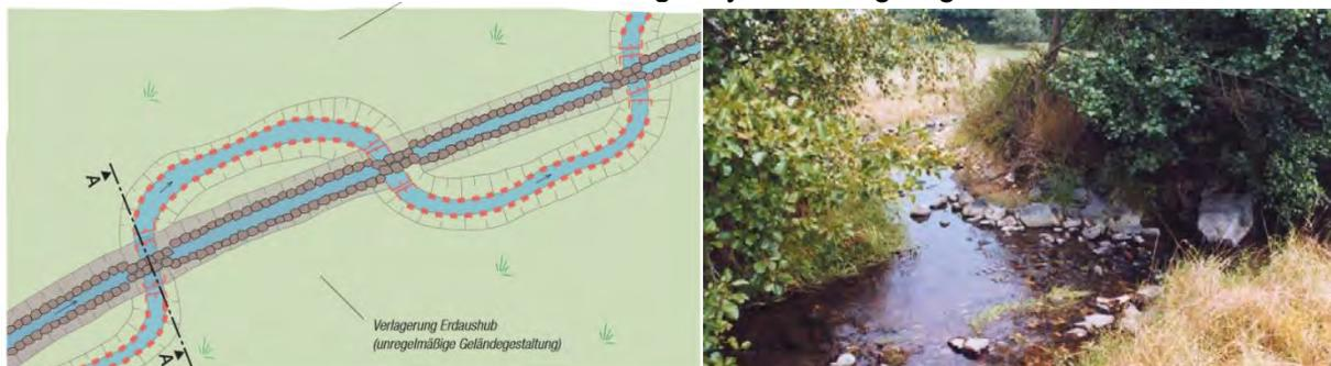
**Abb. 36: Änderung der Linienführung durch Neutrassierung [15]****5) Anschluss von Seitengewässern und Altarmen (LAWA Maßnahmenkatalog [14] Nr. 75)**
