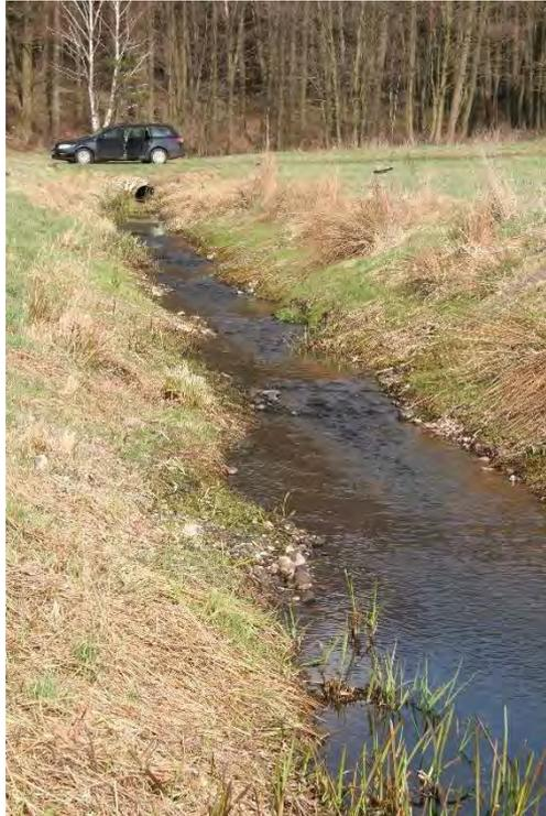
Foto 22: Sohlsicherung an einer geöffneten Verrohrung in Form einer Rausche – Kolk – Gestaltung aus Kiessubstrat
