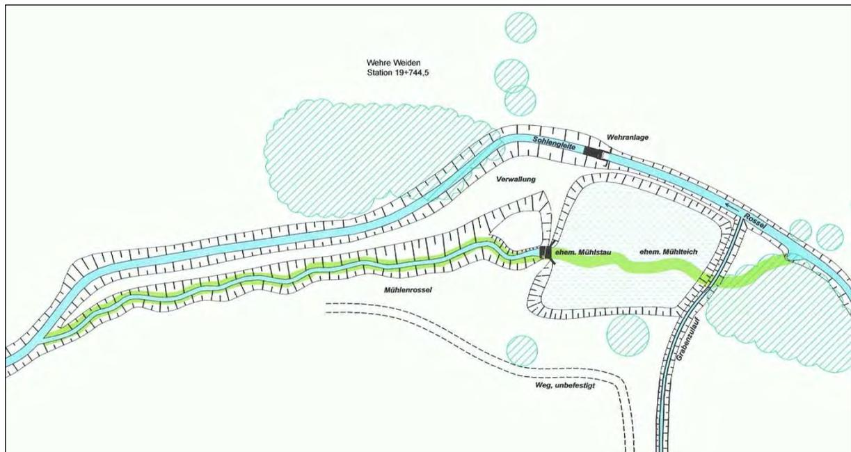
Abbildung 47: Nutzung von Alt- und /oder Ruderalstrukturen zur Umgehung von Ausbaustrecken
