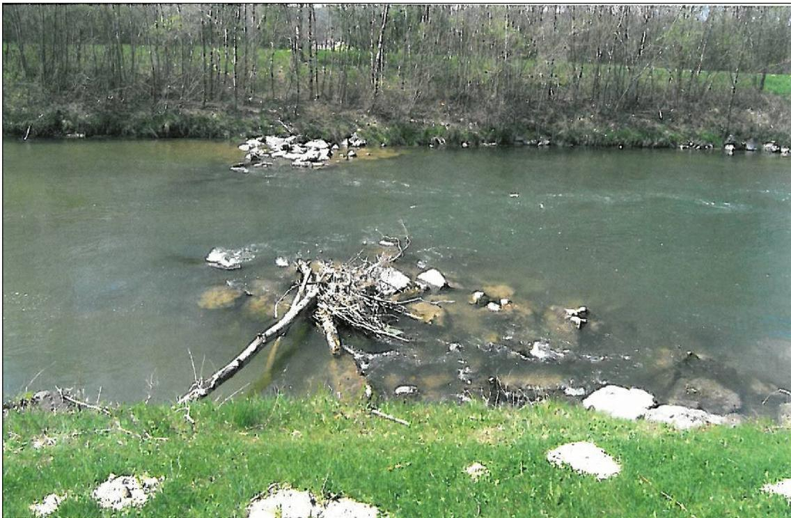
*Abb. 50: Querschnittsstrukturierung mit Steinbuhne, Quelle: [18]*
