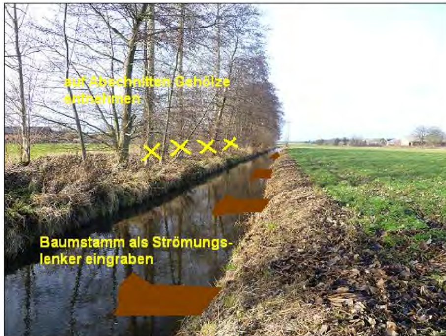
Abb. 5 : Schematische Darstellung, Strömungsenker Salzwedeler Dumme
