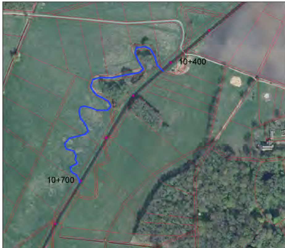
Abb. 6: Neutrassierung Gewässerlauf im Planungsabschnitt SD PA 7
