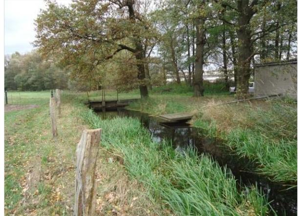
Foto 14: Durchlass mit Stauvorrichtung im Zuge des Grünen Weges – **Löschwasserentnahmestelle** für den Gewerbebetrieb
