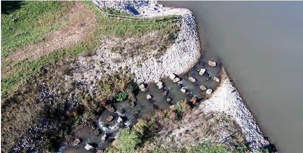
Abb. 25: Beispiel Umgehungsgerinne als punktuelle Maßnahmenvariante
